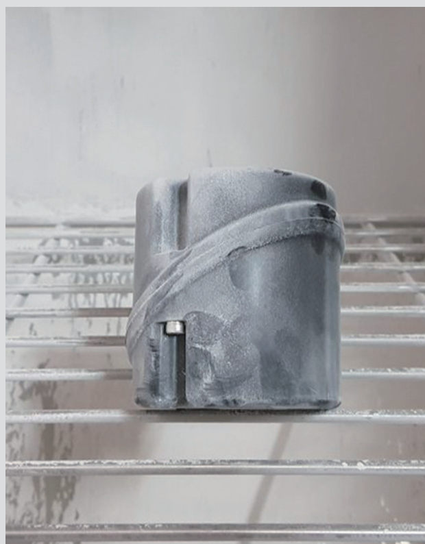
Gehäuse bei IP6x-Test
