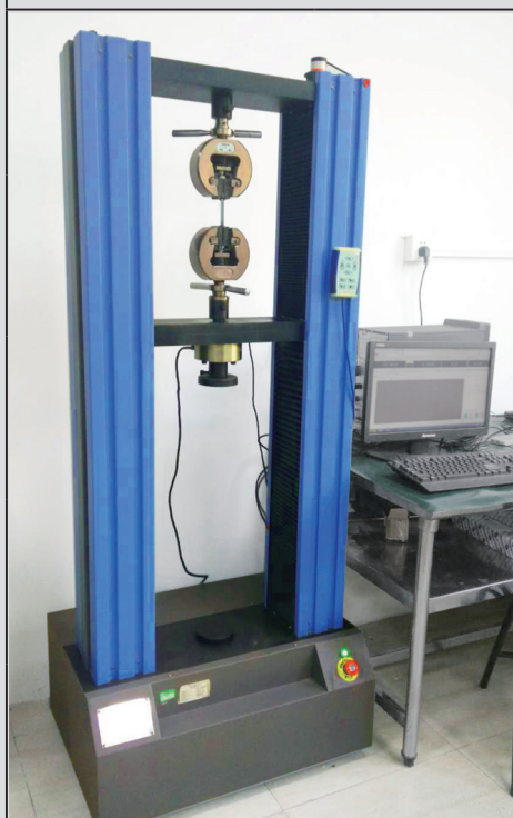
Messausrüstung für die Zugfestigkeit
