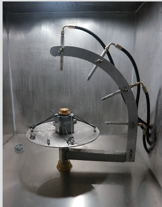
Gehäuse bei IPx9k-Test
